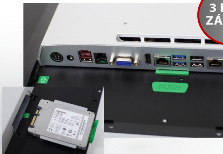
Výměnný pevný disk i celý systémový modul
